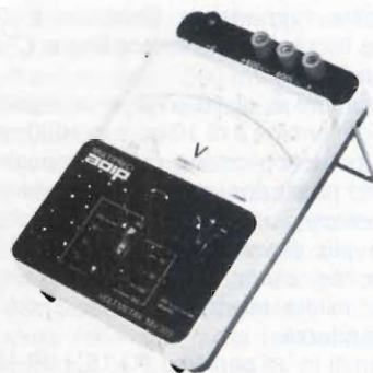
Voltmetro per correnti continue e alternate a norme NFC 42100.
