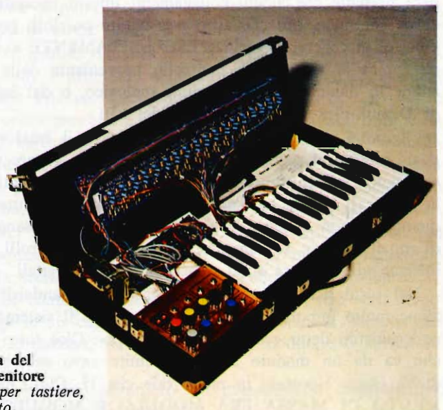
Vista di insieme della tastiera archi/chorus a tre ottave che utilizza il contenitore standard.
