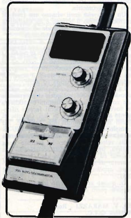
Fig. 3 - Cercametalli con autodiscriminatore modello TR700, GBC ITALIANA codice ZR/9600-00.
