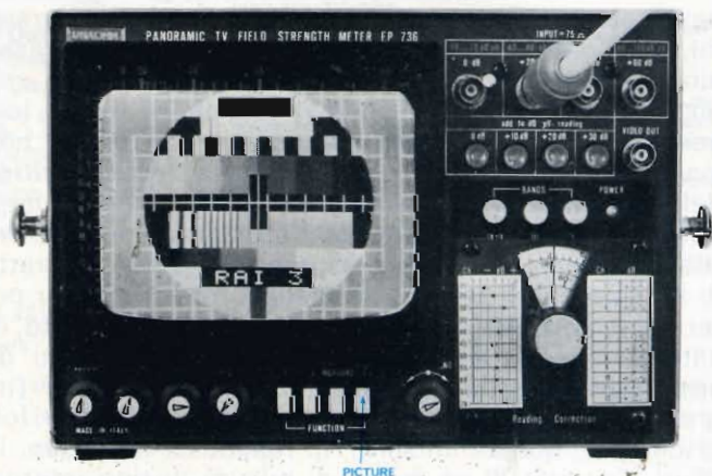
Fig. 7 - Strumento commutato in posizione PICTURE. L'EP 736 si comporta esattamente come un comune televisore. Si avrà in tal modo una fedele visione della qualità del video come se all'antenna fosse collegato l'apparecchio dell'utente. Si tenga soltanto conto che eventuali inconvenienti sull'immagine (disturbi, effetto neve, riflessioni, ecc) vengono esaltati da uno schermo di dimensioni molto maggiori di quello dello strumento che è di soli 6".
